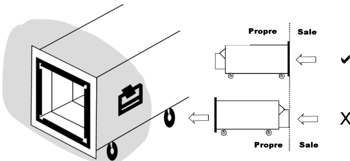
4. Installer le pré-filtre (les plis doivent être à la verticale) et fixer le à la machine avec du ruban adhésif. Le pré-filtre doit être changé sans que la fixation entre le confinement et l'extracteur ne soit retirée.
